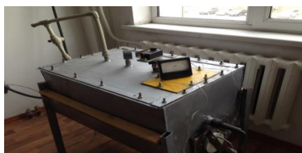
Сурет 1. - Сырты оқшауланбаған және оқшауланған биоэнергетикалық қондырғы
