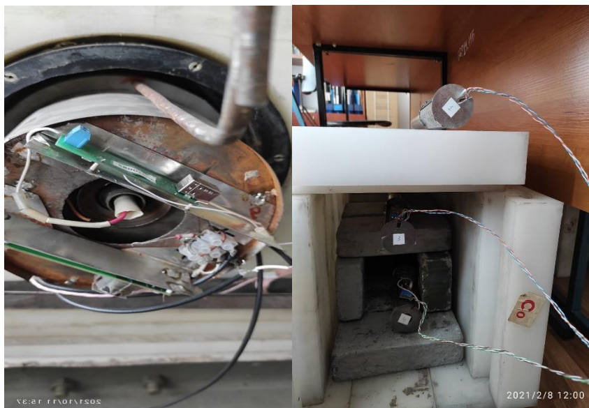
Сурет 1. - СНМ-15, СНМ-18 детекторларының көрінісі және материалдардың конфигурациясы
