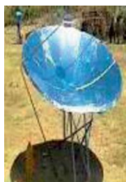
Сурет 1. - Диаметрі 1.8 метр параболалық күн пеші
