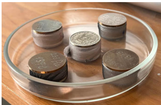
Рис. 1 – Облучение объектов исследования альфа источниками: ^{239}\text{Pu} , ^{238}\text{Pu} , ^{233}\text{U}+^{238}\text{Pu}+^{239}\text{Pu} , ^{226}\text{Ra} .
